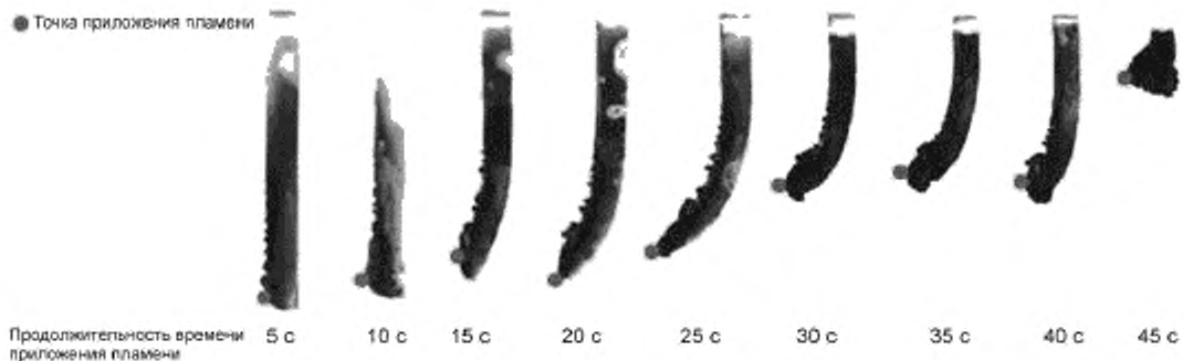
Рисунок А.1 — Точки приложения пламени для образца, который деформируется динамически
